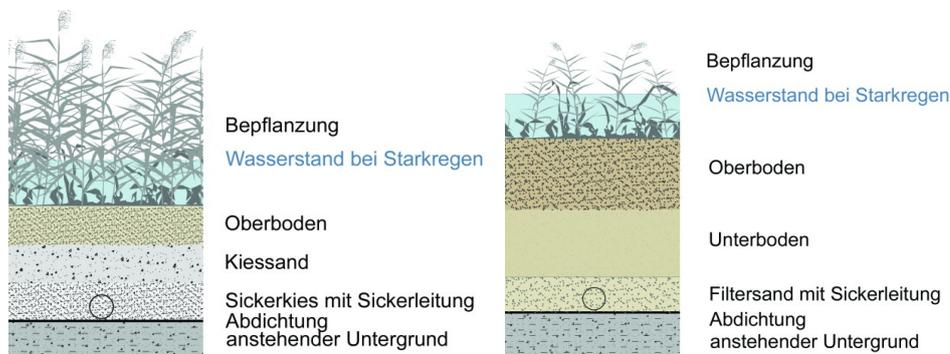
Abb. IV.3 Schematische Darstellung eines Retentionsbodenfilters mit Oberboden auf Kiessand (links) und mit Oberboden auf Unterboden (rechts).
