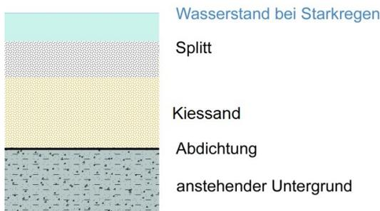
Abb. IV.6 Schematische Darstellung eines Splitt-Kiesfilters.
